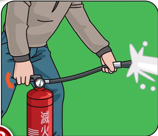
**3 壓** 壓下手壓板，滅火劑噴出
